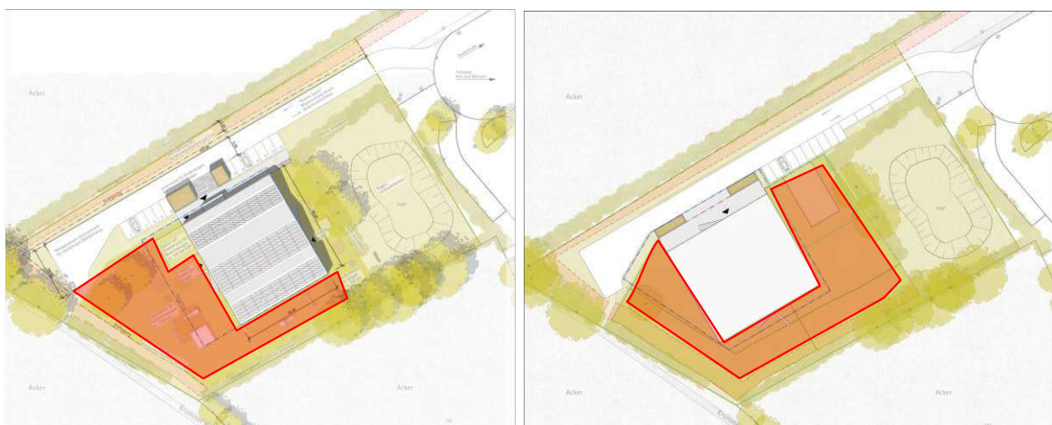
Abb. 32.: Gebäudeverschiebung, Verlagerung Außenspielgelände (rechts)
